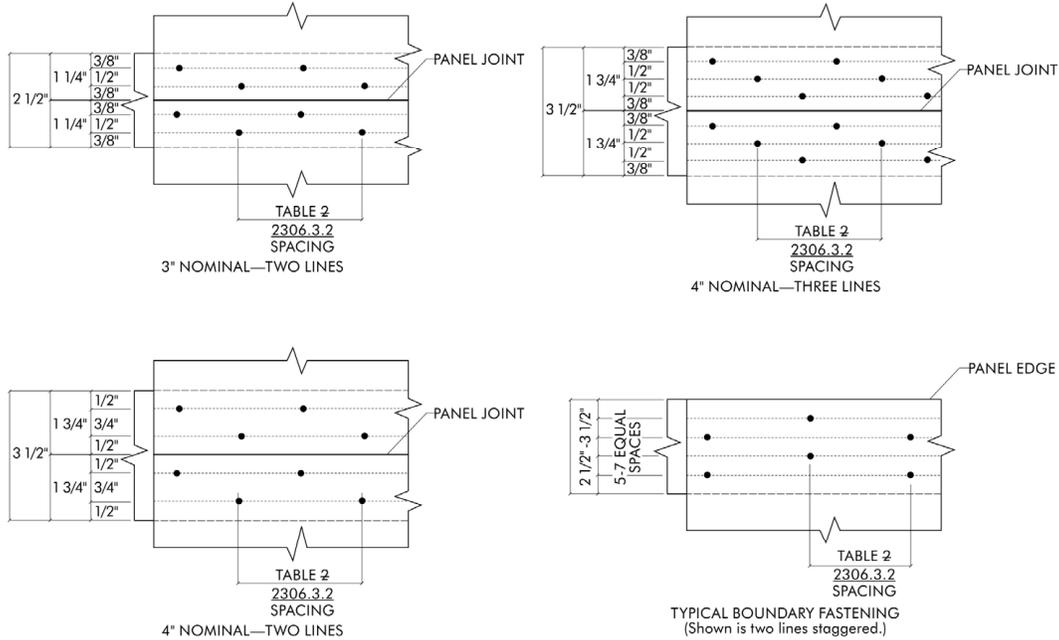
NOTE: SPACE PANEL END AND EDGE JOINT 1/8-INCH. REDUCE SPACING BETWEEN LINES OF NAILS AS NECESSARY TO MAINTAIN MINIMUM 3/8-INCH FASTENER EDGE MARGINS, MINIMUM SPACING BETWEEN LINES IS 3/8-INCH
