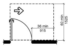
(d) Hinge Approach, Pull Side (d) hinge approach, pull side
